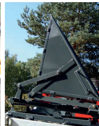
Schornsteinkübel mit Fahrschlitten
