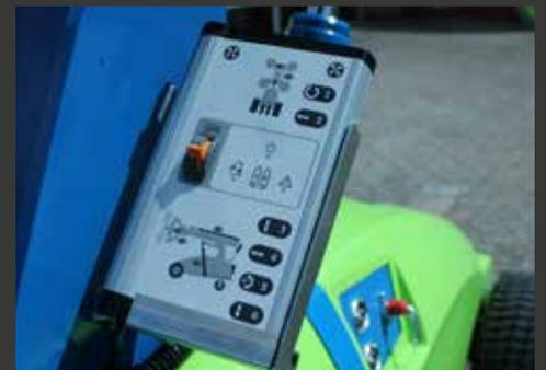
Das Multifunktions-Bedienpanel in bedienerfreundlichem Design mit integrierten Bedienknöpfen und Signalleuchten, doppelt gesicherte Sicherheitsschalter und automatischer Lastausgleich gehören zur Standard-Ausrüstung des Winlet 785.
