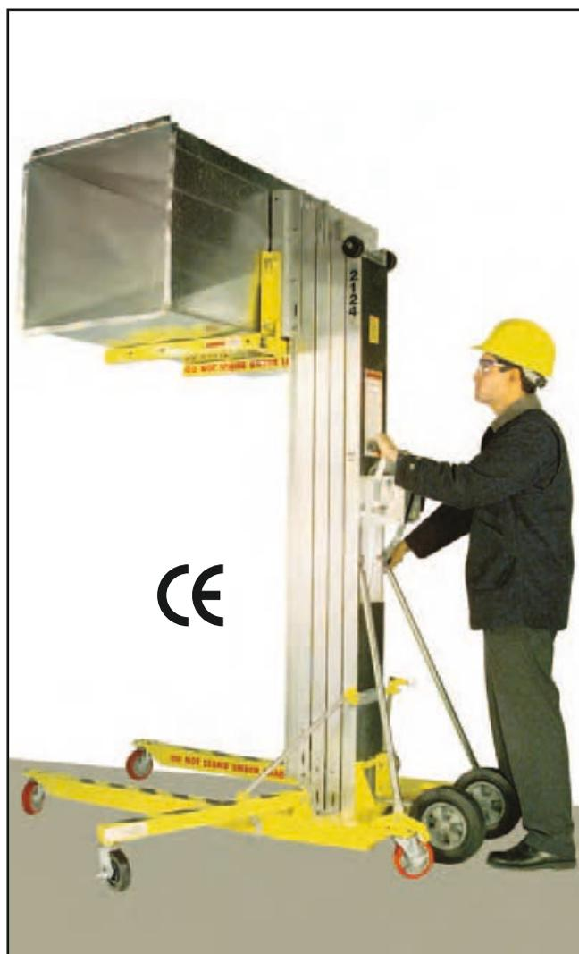
Die Series 2100 ist ein unvergleichlicher Universal-Montagelift, der einen höheren Mast zum Erreichen der gewünschten Arbeitshöhen mit weniger Mastsegmenten hat. Daher ist der 2100 billiger und leichter. Basis, Gabeln, Winde, usw. entsprechen denen der Series 2000.
