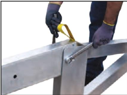
**3** Befestigen Sie einen Bolzen an jedem Dreieckssrahmen
