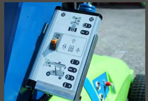
Ein Anwenderfreundliches Multifunktion Bedienpult mit integrierten Drücktasten und Kontrollleuchten., doppelwirkende Sicherheit Drücktasten, Gyro Funktion sind alle in der Standard Konfiguration der Winlet 785.
