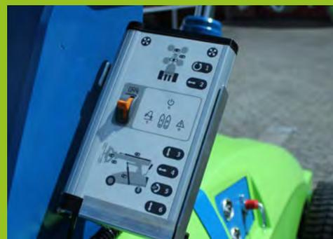
Der Multifunktions Bedienpult im Anwenderfreundlichem Design hat integrierte Drucktasten und Signallampen. Voller Überwachung der Traglastkapazitäten für Erhöhter Sicherheit.
