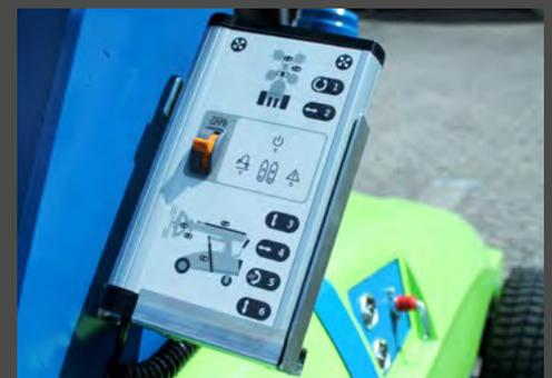
Ein Anwenderfreundliches Multifunktion Bedienpult mit integrierten Drücktasten und Kontrolleuchten., doppeltwirkende Sicherheit Drucktasten, Gyro Funktion sind alle in der Standard Konfiguration der Winlet 1000.
