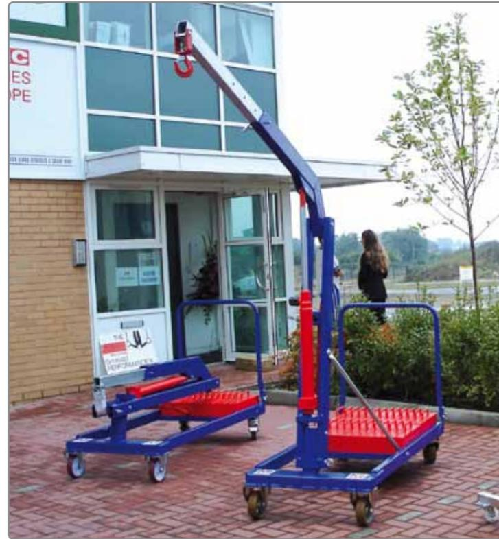
Bei der Montage und Demontage punktet der KS GK ebenfalls. Der Kranausleger lässt sich nach hinten umklappen und so gut in das Montagefahrzeug verstauen. Wer es noch platzsparender mag, kann den KS GK einfach zerlegen und ohne großen Kraftaufwand wieder zusammenbauen.
