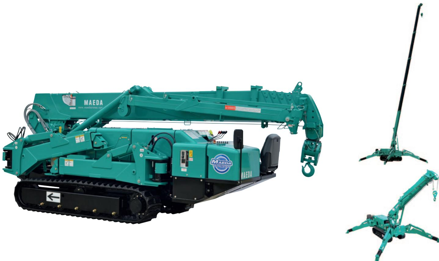
Der MC 405 ist der leistungstärkste der Baureihe MC mit einer Tragkraft von 3,83 t. Der optionale Fly Jip vergrößert den Arbeitsbereich noch weiter, zudem ist der MC 405 noch mit 500 kg Last verfahrbar.
