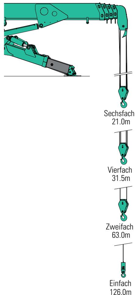
Das Arbeitsbereich-Diagramm zeigt die Gesamtlast einschließlich der Reichweite des Auslegers und der Kranspitze.
